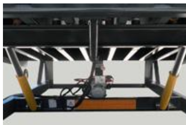
RH2 și RH3 dispun de doi cilindri de ridicare cu Ø50mm cu tijă.
