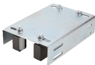
Ghidaj superior reglabilă cu 4 role din teflon
